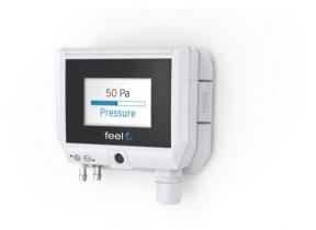
差压变送器 feel FDP 非常适合用于过滤器监控、体积流量控制或房间压力监控等场景下极细微差压的精确测量。由于采用了精密传感器元件和高分辨率测量电子设备,其精度可达 ±0.2%。用户可通过 DIP 开关、蓝牙或软件,根据现场条件对测量范围、单位或输出信号等参数进行调整。对于对长期稳定性有较高要求的应用,自动调零选项可实现多年的测量值稳定性。可选配高分辨率 2.8 英寸 TFT 显示屏。为便于安装,随附卡入式框架和所有安装附件。
